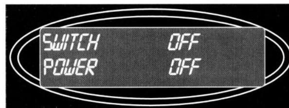
DIP-Switch Schalter 8 auf DIP-Switch Paket C auf Stellung OFF und Apparat ausschalten.
